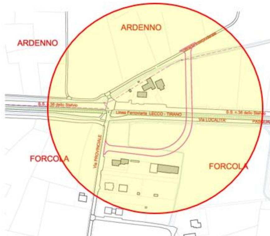
Figura 3 – Ambito di intervento della nuova viabilità di connessione
